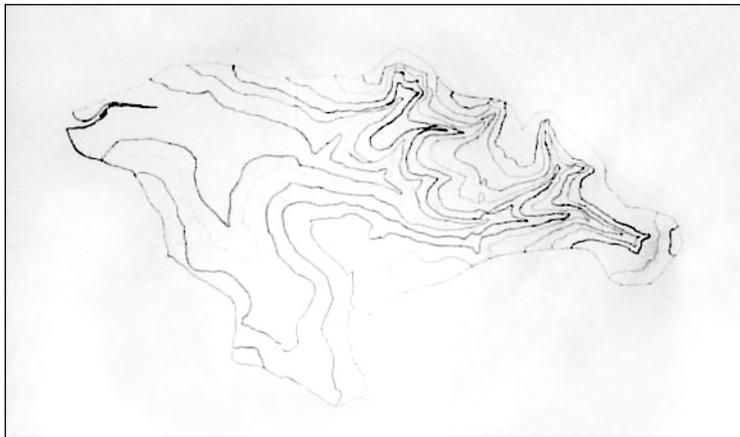
**Figura 4.2** Intercalação e transposição das curvas de nível.
